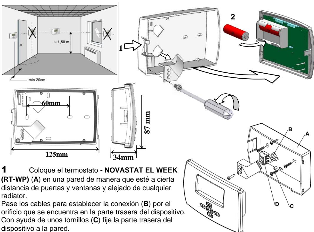
**1** Coloque el termostato - NOVASTAT EL WEEK (RT-WP) (A) en una pared de manera que esté a cierta distancia de puertas y ventanas y alejado de cualquier radiador.
