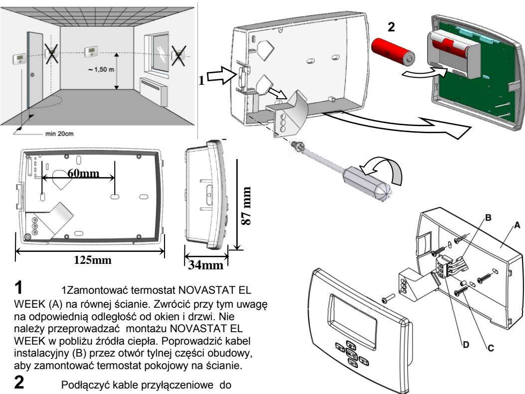
**1** Zamontować termostat NOVASTAT EL WEEK (A) na równej ścianie. Zwrócić przy tym uwagę na odpowiednią odległość od okien i drzwi. Nie należy przeprowadzać montażu NOVASTAT EL WEEK w pobliżu źródła ciepła. Poprowadzić kabel instalacyjny (B) przez otwór tylnej części obudowy, aby zamontować termostat pokojowy na ścianie.
