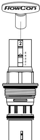
Zur Einstellung des Volumenstroms den FlowCon Einstellschlüssel (Art.-Nr. ACC0001) verwenden.
