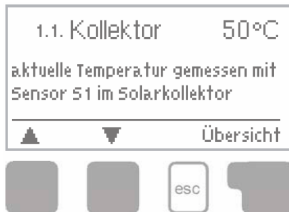
Fig. 8-6: Affichage de la valeur de mesure sélectionnée "Température du collecteur solaire"
