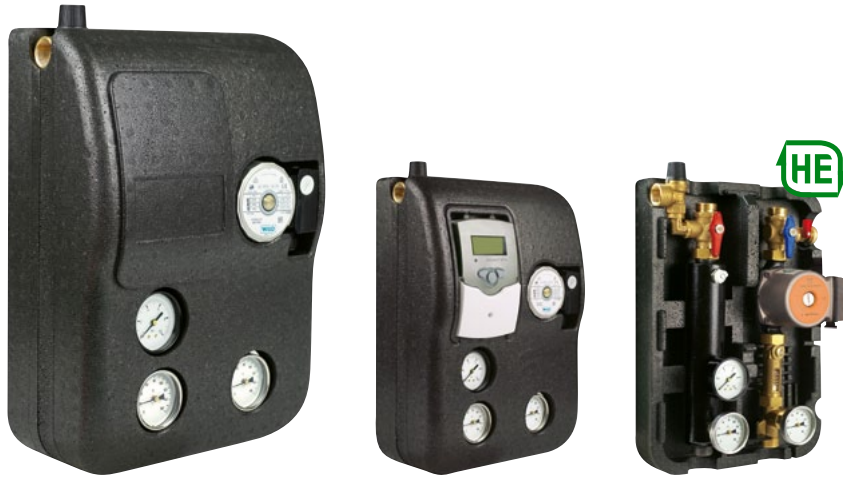
Zweistrang-Pumpengruppe mit Abgleichventil, Entlüftungseinheit und Sicherheitsgruppe für Solarthermie-Anlagen
