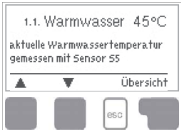
Abb. 8-6: Anzeige ausgewählter Messwert „Warmwassertemperatur“
