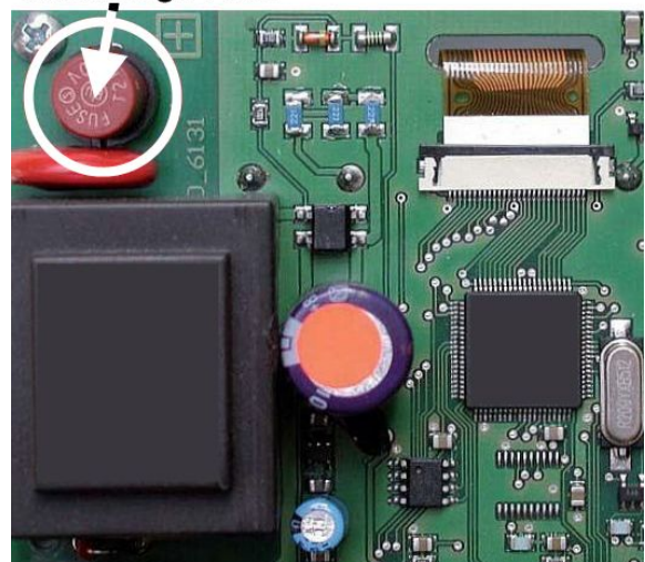
Abb. 11-2: Positionierung der Sicherung im Regler
